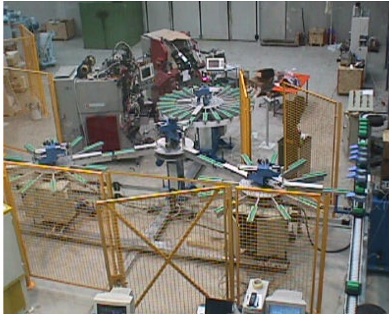
Fig. 7.2.2 – Modulo di manipolazione e trasporto
